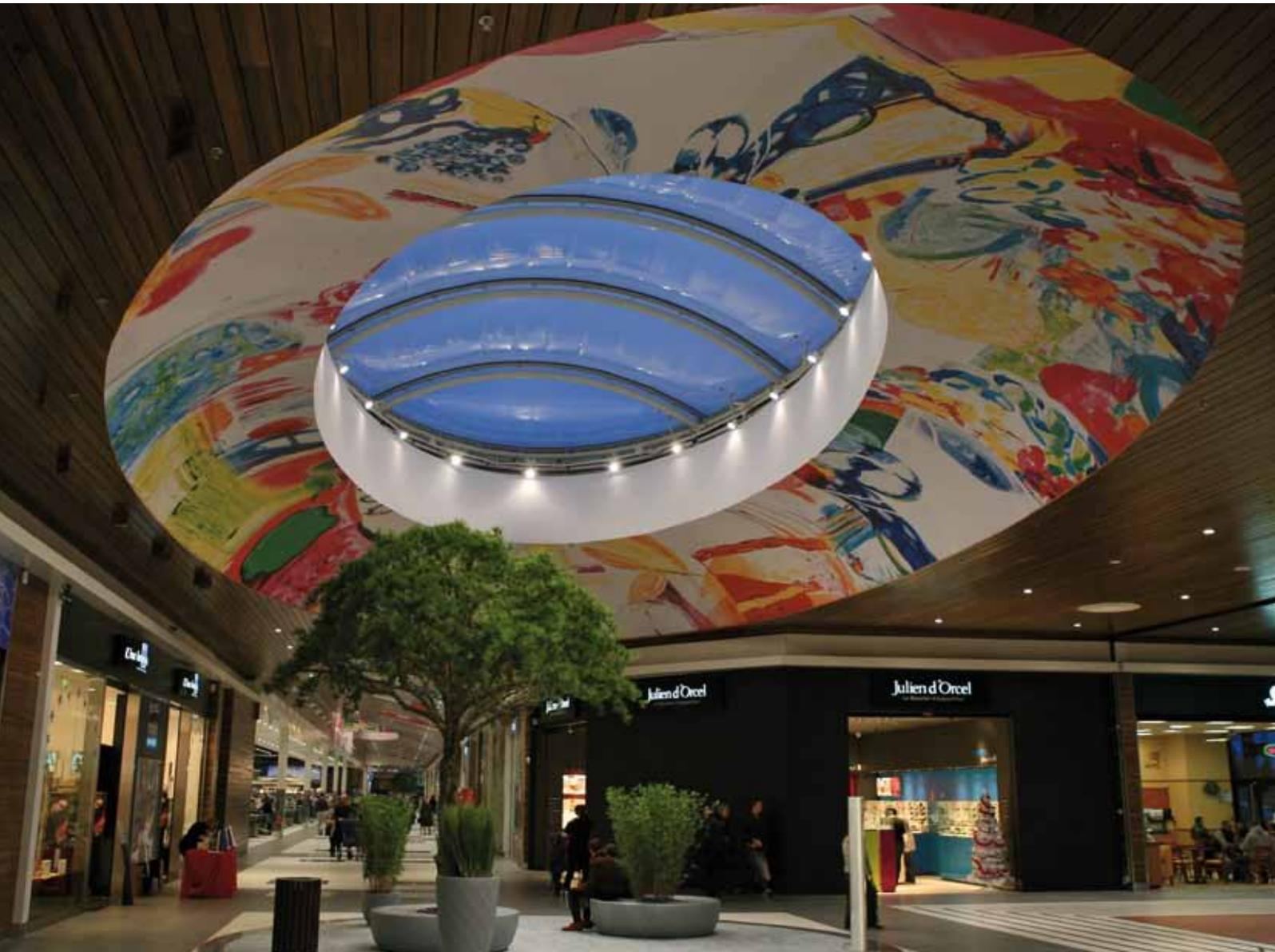
AU CENTRE COMMERCIAL LECLERC DES PORTES DU VALOIS, TROIS LANTERNEAUX ET TROIS COUVERTURES ONT ÉTÉ CONSTRUITS AU NIVEAU DES ACCÈS À L'ÉDIFICE. À L'EXTÉRIEUR UNE COUVERTURE MONOCOUCHE EN ETFE ET À L'INTÉRIEUR LES LANTERNEAUX AVEC COUSSINS EN ETFE SONT UNE SOURCE DE LUMIÈRE QUI ENRICHT LA DÉCORATION INTÉRIÈURE DU CENTRE COMMERCIAL.
